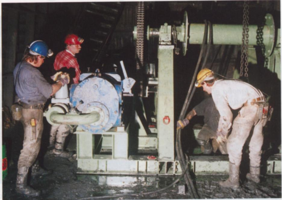
Damit das Großband (Diagonal 4603 von der 4. zur 5. Sohle) beim Ausbau nicht aus der Rolle fällt, bauen die SJ-Mitarbeiter die Bandwickelmaschine auf.
