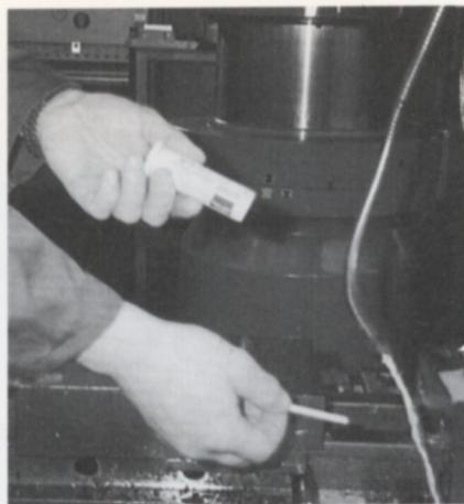
Mit einem Nitrit-Teststäbchen wird der Nitritgehalt geprüft.
