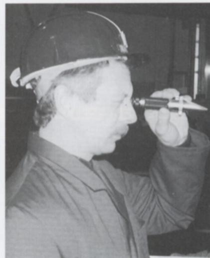
Siegfried Ritzert prüft mit einem Handrefraktometer die Gebrauchskonzentration.
