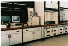
Gas-Chromatograph und zwei Digestorien im Wasserlabor
