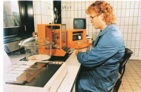
Wägeraum mit Analysewaage, Rechner und Drucker
