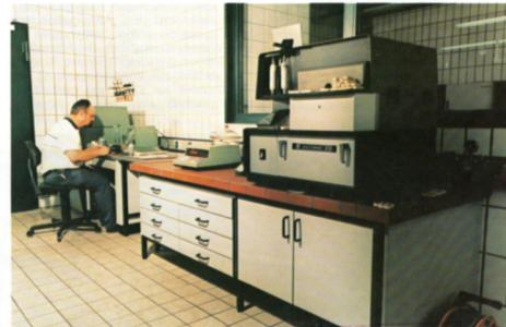
Analysegeräte zur Bestimmung von Kohlen-, Wasser- und Stickstoff (im Hintergrund) sowie Schwefel (vorn)
