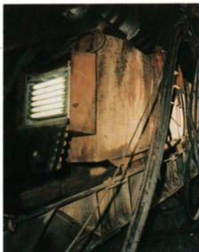
Mitgeführte flexible Wasserleitung über dem Kettenkratzerförderer (Bild 2)
