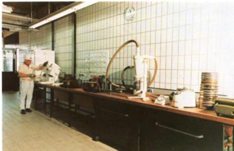
Großer Laborraum im Erdgeschoss mit Flotations- und Feinstsiebmaschine
