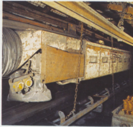
Trockenfilterentstauber „Optimat“ im Teilschnitt-Vortrieb
