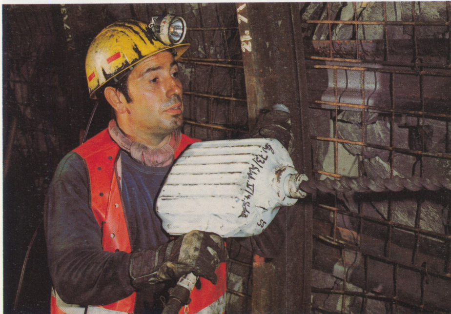
Schallgedämpfte Kohlendrehbohrmaschine „Fortschritt III“
