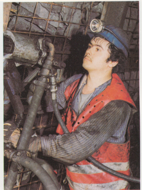
Schallgedämpfter Bohrerhammer „SIG PLB 23“
