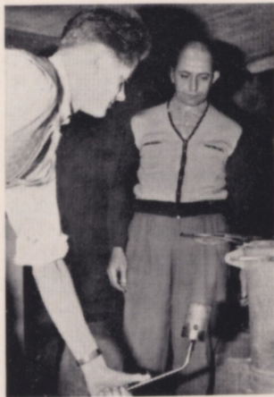
Emaillpulver wird in eine Kupferplatte gebrannt.
