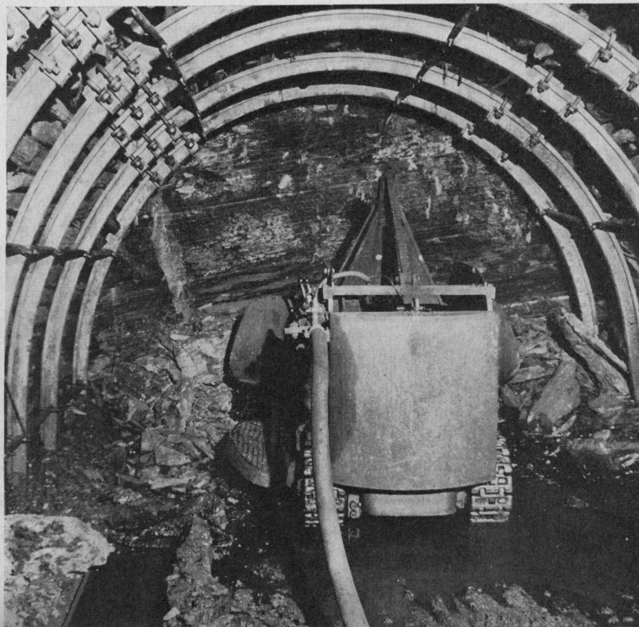
Raupenlader im Abbaustreckenvortrieb Flöz Merl, Revier 7
