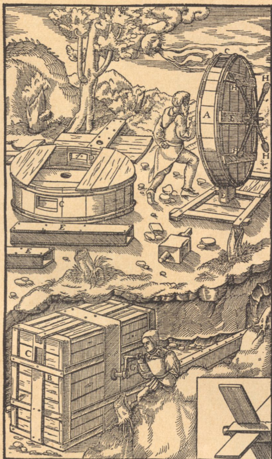
Die Trommel A. Der rechteckige Behälter B. Das Luftloch C. Die andere Öffnung D. Die Lutte E. Der Rundbaum F. Die Kurbel G. Die Stangen H.
