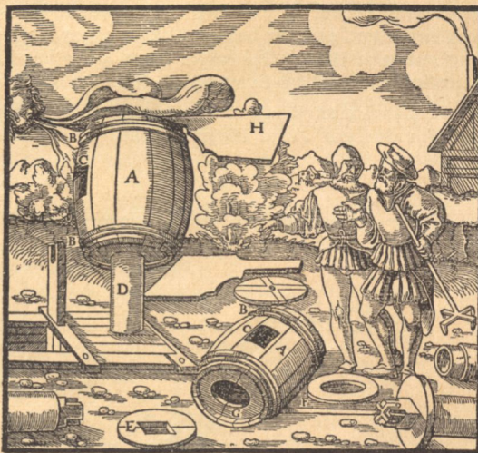
Das hölzerne Faß A. Die Reifen B. Die Windöffnung C. Das Rohr D. Die Scheibe E. Die Achse F. Die Öffnung im Boden des Faßes G. Der Flügel H.
